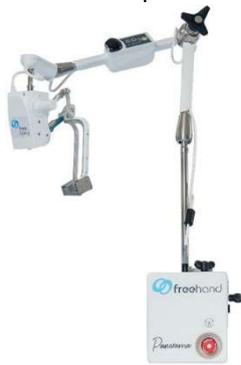
L'elemento Zoom monouso è progettato per essere utilizzato per un servizio cumulativo massimo di 8 ore con il tempo di accensione del motore non superiore a 20 minuti. Il sistema FreeHand è progettato per un uso normale per un periodo di sette anni.
